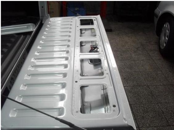
2) Lösen Sie die beiden Muttern, die den äußeren Griff mit der Heckklappe verbinden.
